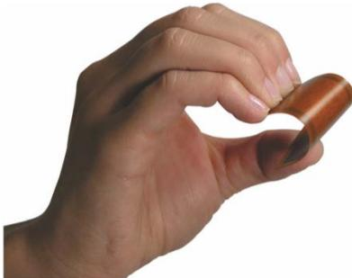
Abb. 3 Biegeradien bis 20 mm lassen sich mit den Flächenwandlern ohne weiteres realisieren
