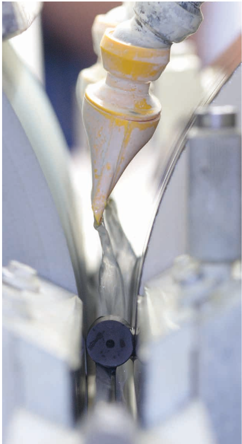
Spitzenloses Rundschleifen von piezokeramischen Stäben
