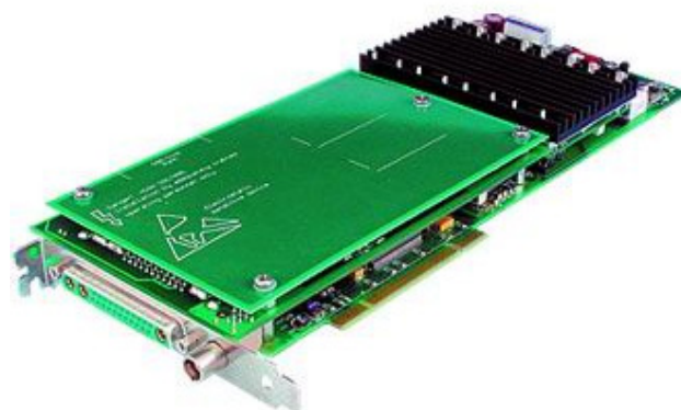
Abb. 7 Die als PCI-Board aufgebaute Controllerkarte ist speziell auf die Ansteuerung von mehrachsigen Piezo-Nanopositioniersysteme abgestimmt
